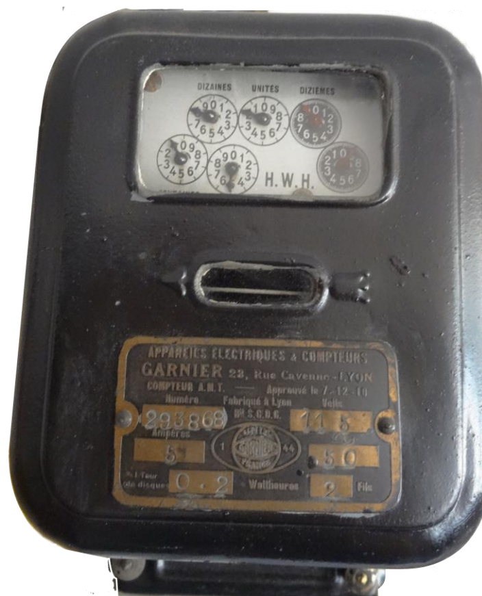
Compteur d'électricité de 1910 (Électrodrome)
